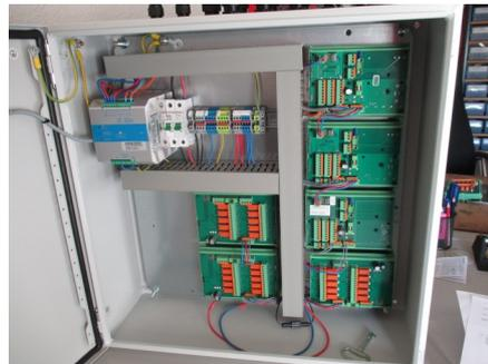
Einbau der Basiselektronik: Spannungsversorgung, Eingänge für die Messfühler, Steuerausgänge.
